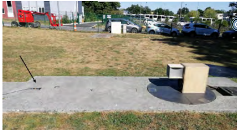
Figure 3. Configuration de mesure extérieure pour une mesure de perte acoustique typique. La flèche indique la position du microphone.
